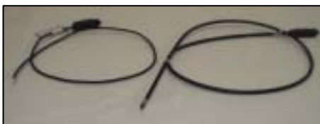
3.9mm φと5.5mm φのカメラケーブル
