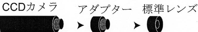
オプションのレンズアダプターを、CCD カメラ本体と標準レンズの間に取り付けることで、拡大（マクロ）撮影が可能になります。アダプターは、最大 3 個まで重ねて取り付けることができ、アダプターの数が多いほど、拡大倍率が上がります。
