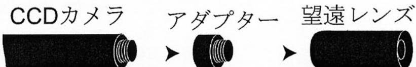
拡大撮影時、カメラ付属の標準レンズの代わりに、オプションの望遠レンズを使用することで、被写体距離をおいての拡大に対応できます。
