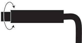
先端レンズ部を回し、フォーカス(焦点)を調整します。
